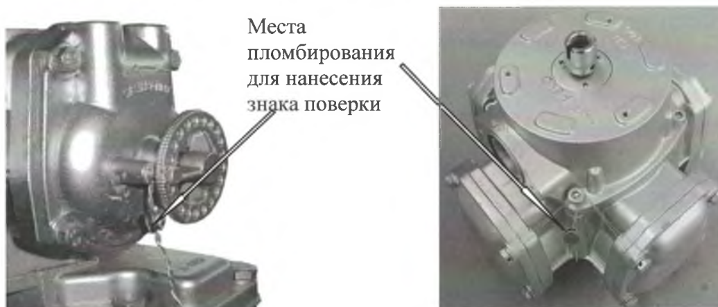
Рисунок 3 - Схемы пломбировки объемного счетчика жидкости типа RSJ-50 и нанесения знака поверки
